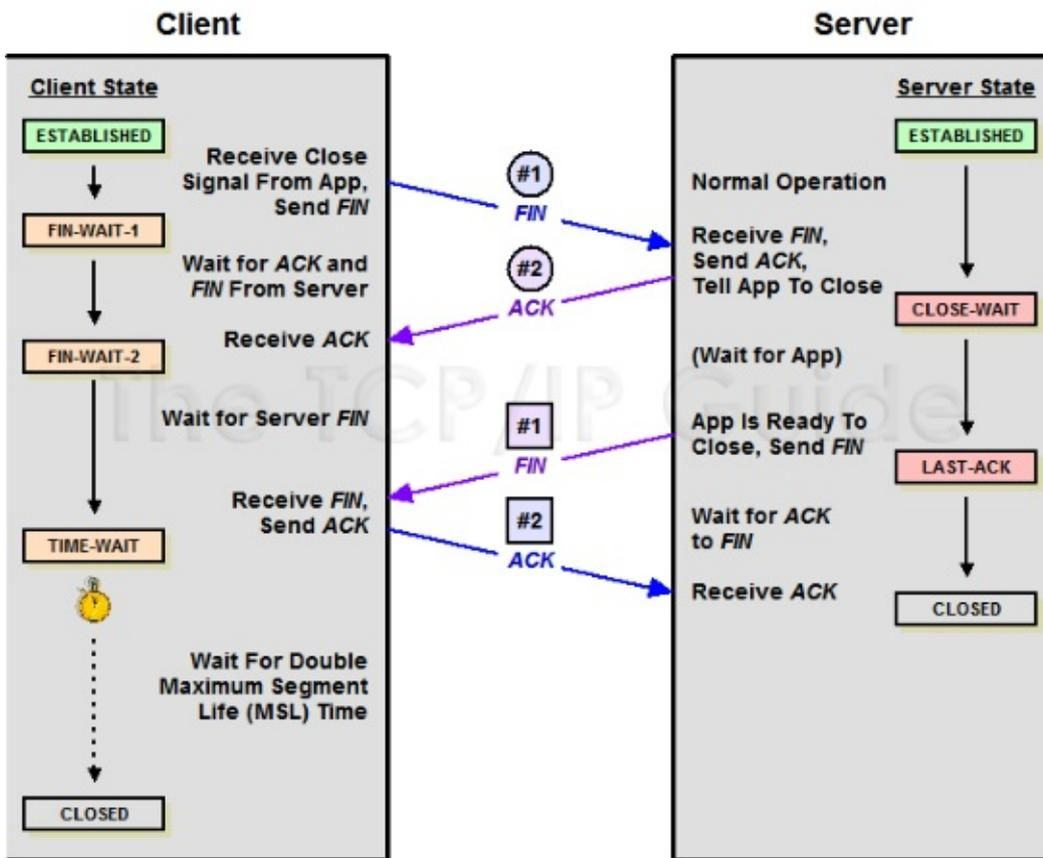
因为 `TCP` 连接是双向的，所以在关闭连接的时候，两个方向各自都需要关闭。先发 `FIN` 包的一方执行的是主动关闭；后发 `FIN` 包的一方执行的是被动关闭。主动关闭的一方会进入 `TIME_WAIT` 状态，并且在此状态停留两倍的 `MSL` 时长。
