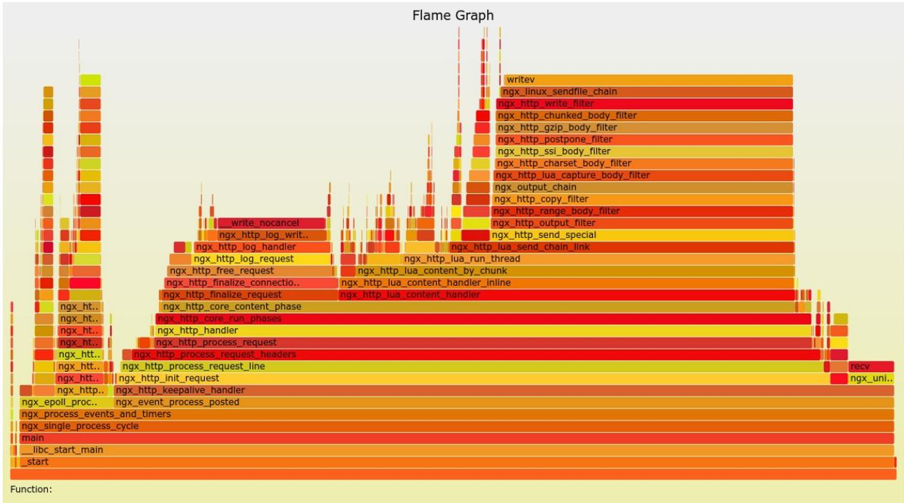
从上图可以看出，正常业务下的火焰图形状类似的“山脉”，“山脉”的“海拔”表示 worker 中业务函数的调用深度，“山脉”的“长度”表示 worker 中业务函数占用 cpu 的比例。
